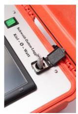
Die erfassten und ermittelten kumulierten Messwerte werden als XML-Datei in Tabellenform abgespeichert. Sie können sie wahlweise mittels USB-Stick für die weitere Bearbeitung und Archivierung auf einem PC übertragen oder direkt über einen optionalen Drucker ausdrucken.
