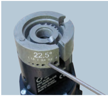
Elektroden anschleifen: 4 unterschiedliche Winkel, 6 unterschiedliche Elektrodendurchmesser
