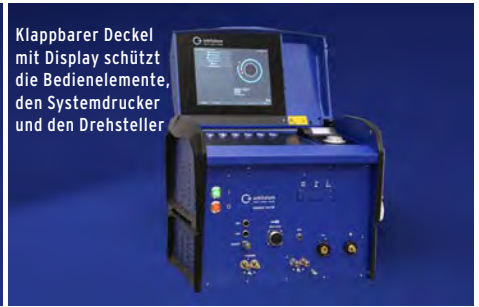
Das integrierte Flüssigkeitskühlsystem hält angeschlossene Schweißzangen und -köpfe stabil auf Temperatur
