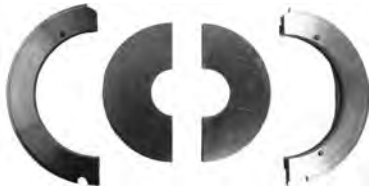
Einsatz zum Bogenschweißen (Grundaufnahme/Abdeckscheibe)
