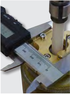
Einfache und präzise Einstellung der Elektrodenposition
