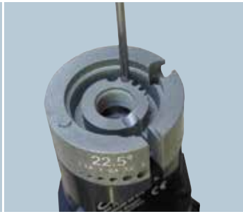
Elektroden spitze anplanen
