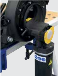
Inklusive zweite Sägeblattaufnahme zum Herausräumen von Rohrbögen
