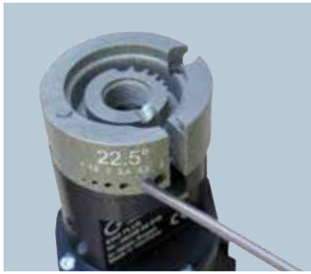
Elektroden anschleifen: 4 unterschiedliche Winkel, 6 unterschiedliche Elektrodendurchmesser
