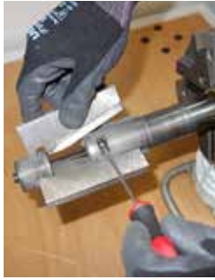
Schnelle Einstellung der Rohrdimension
