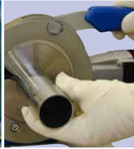
Schnellwechselsystem für Werkzeuge, Spannschalen und Rohre
