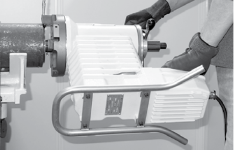
Durch integrierten Griff auch sehr mobil zum Rohr hin einsetzbar
