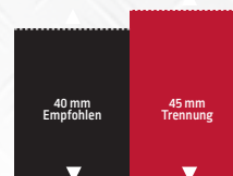
TH 1538 Empfohlen bis zu 40 mm Unlegierter Stahl (Trennung 45 mm)
